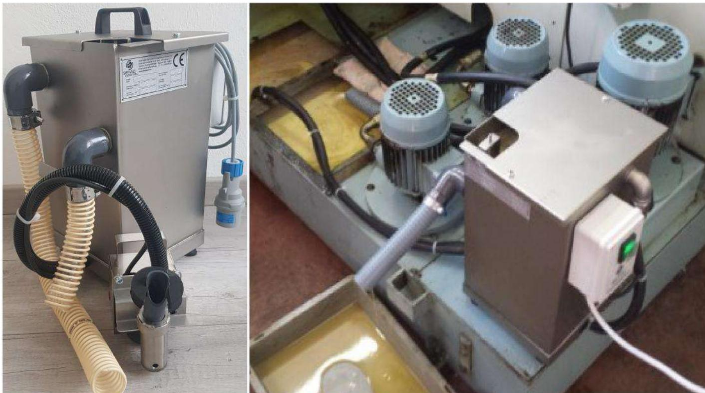
Disoleatore Personal è appositamente progettato per il bordo macchina. Ha un volume ridotto e può essere trasportato con qualsiasi mezzo.
